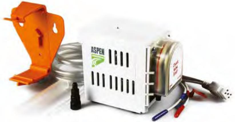
La pompe Universal est le modèle le plus vendu de la gamme. Elle fonctionne avec deux sondes de température. Son système péristaltique rotatif engendre une pression continue ce qui permet de la placer jusqu'à 3 mètres sans que sa performance n'en soit affectée.
